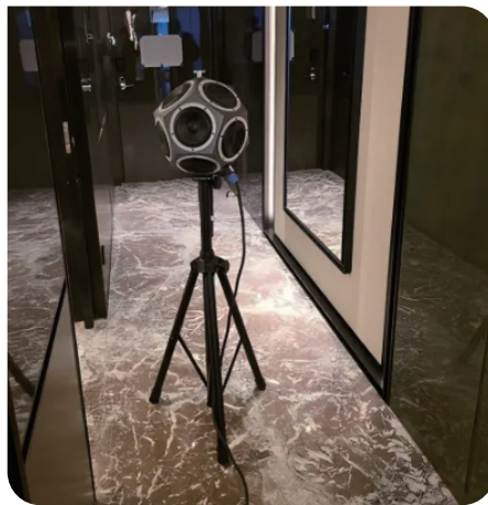
圖：建築聲學專業測量設備，用於對建築構件隔聲測量，確保工程質量和環境合規性
