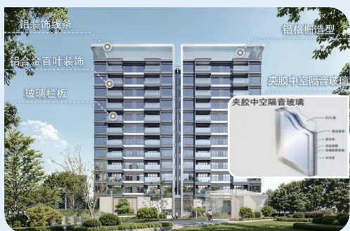
越秀·星匯燈湖的三玻夾膠中空玻璃效果圖
